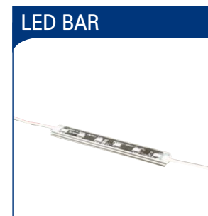
품 명 LLE-ST12-200F IP등급 IP67 전 략 2.9W 규 격 200(W)×4.95(H)×13.7(D)mm
